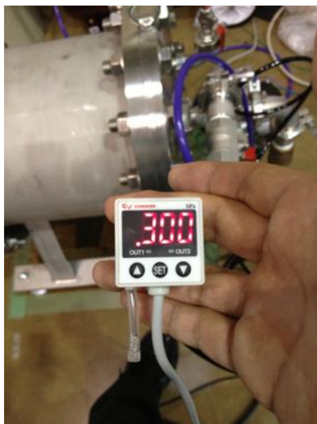
図 2-18 デジタル式圧力計
