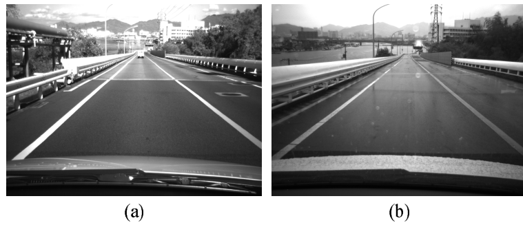
図 4.9: テスト画像例: (a) 乾燥路面, (b) 湿潤路面.
