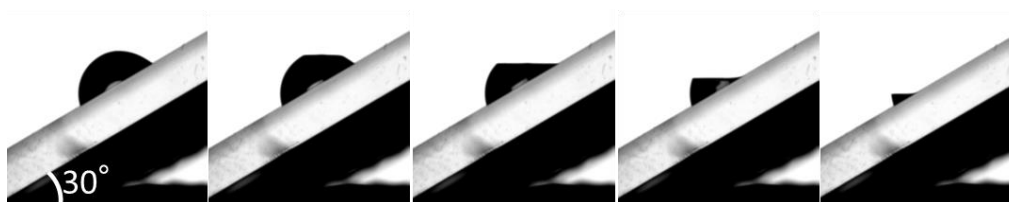
Fig. 3-8 HFBI 液滴をのせた FTO 基板を 30°傾けた実験
