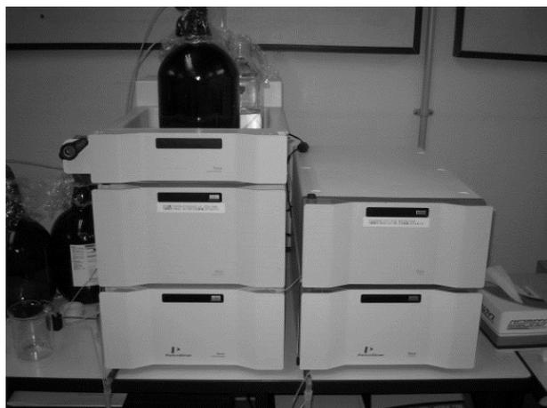
Fig. 5-4. 竹酢液分析に用いた液体クロマトグラフ
