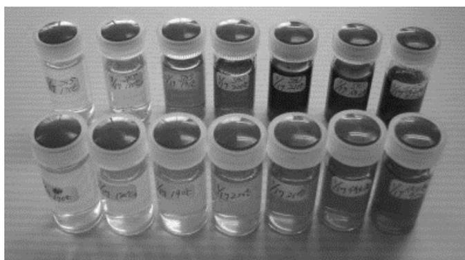
Fig. 5-3. 回収した竹酢液(上段：回収口①, 下段：回収口②)
