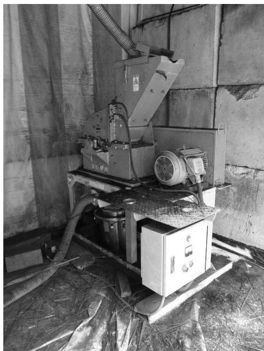
Fig. 2-3-1. 破碎機(奈良機械製作所製ハンマーミル HM-5)
