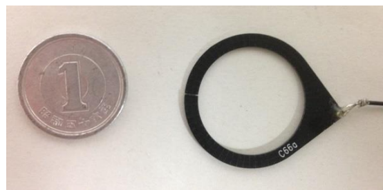
図 6 PCB 電流センサ (3)
