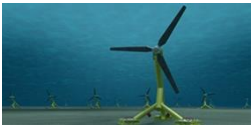
図 1-4 潮流発電装置 (ANDRiTZ Hydro Hammefest) (7)
