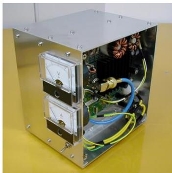
写真 4 ワイヤレス給電送信装置
