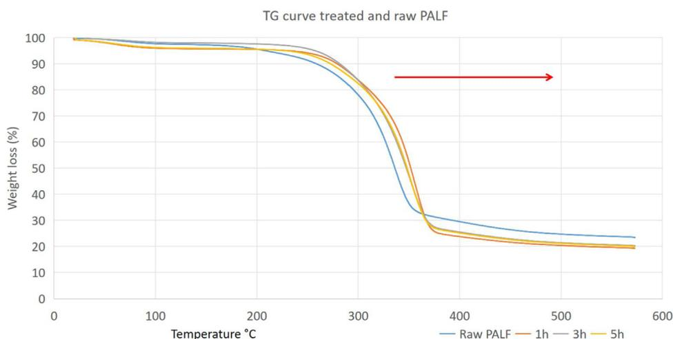
Fig. 10 – TG Curve of Yankee’s PALF.
