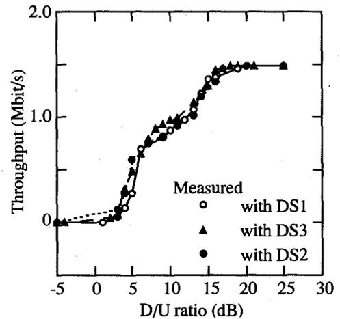
Fig. 4 Measured throughput of the FH system with a DS1, DS2 or DS3 disturbance source.
