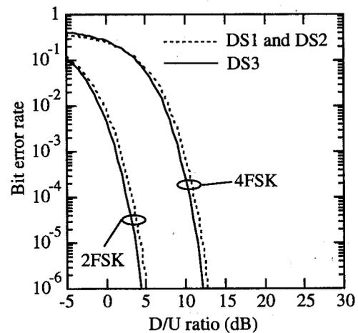
Fig. 8 Calculated bit error rates of the FH system with a DS1, DS2 or DS3 disturbance source.
