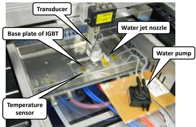
Fig. 2 DUT Setup
