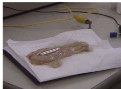
図3. ブタの腸の上での走行実験
