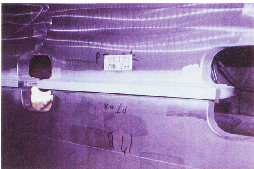
図6.15 十字すみ肉溶接後のAl/SUSクラッド材の浸透探傷検査状況
