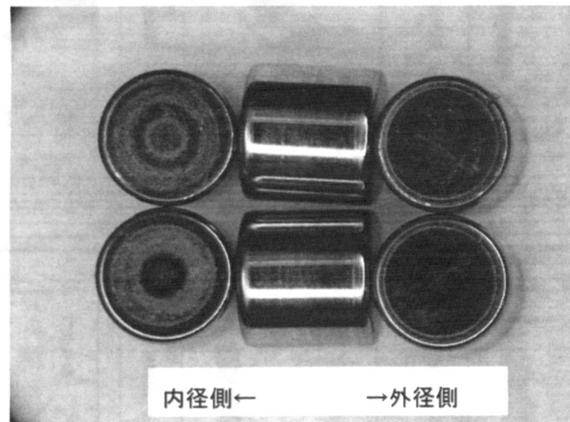
図 7.10 試験後の軸受部品 (02-5-18, #213-1, 970h, 未寿命側)
