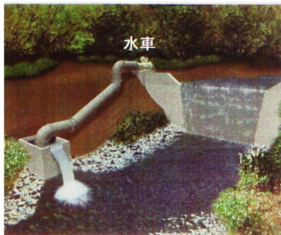
(b) 水車をダムの上端部に設置
