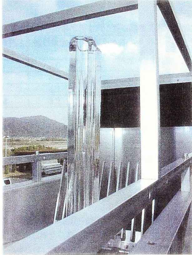
図 3-11. メッキ廃水中から生成した氷結晶写真
