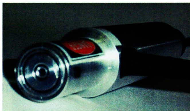
図6-36 外曲面検査装置の外観
