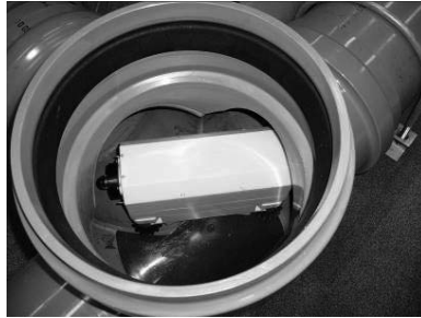
Fig. 16. KANTARO turning in the manhole.
