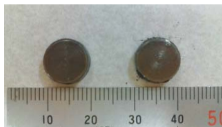
図 3 ナノ細孔構造 p 型 \text{Bi}_2\text{Te}_3
