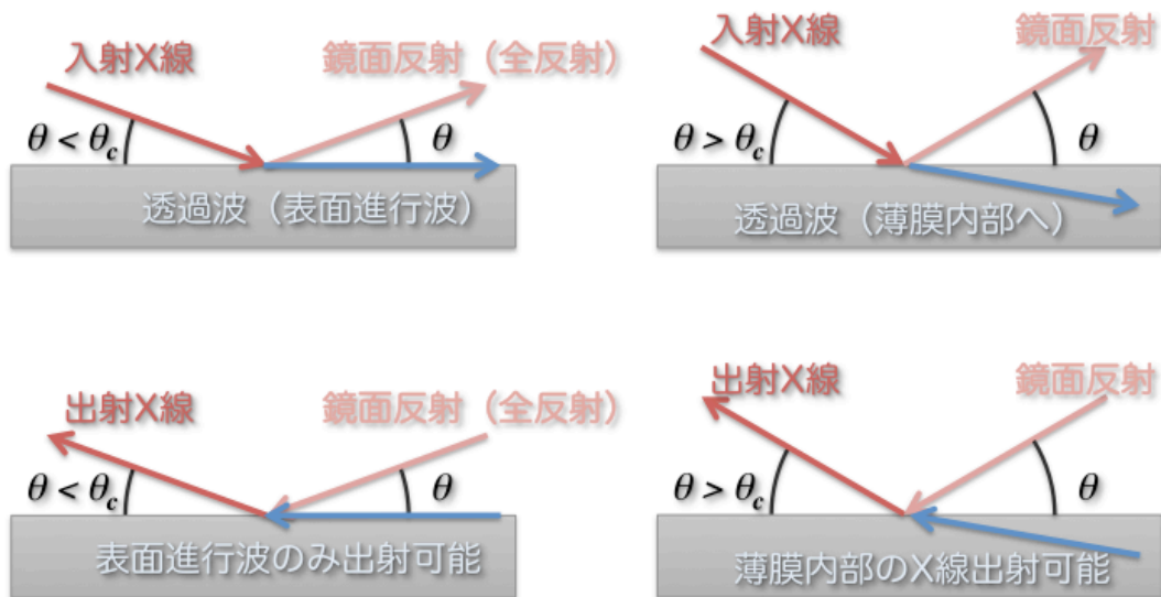
図 1.14 全反射臨界角度近傍の X 線の振る舞い
