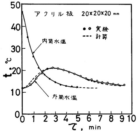
第7図 数値解と実験結果の比較および内筒水温の時間的な変化
