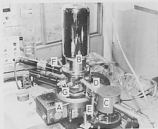
写真1 試料全面のトポグラフを得るときの光学系と低温試料ステージの試作装置全体
