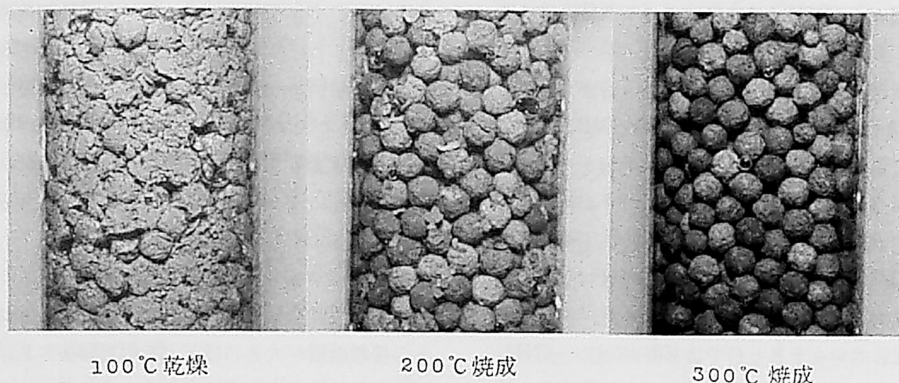
第8図 通水中における充填層のペレットの状態 (ペレット; B-5-5)
