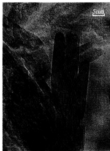
プレート状ルチル酸化チタン微粒子の HRTEM 像
