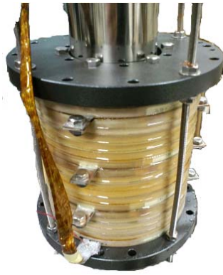
図5 液体窒素中で動作する超伝導磁石。 77 K で 0.70 T、減圧液体窒素中(65 K)に おいて、1.30 T を発生できる。
