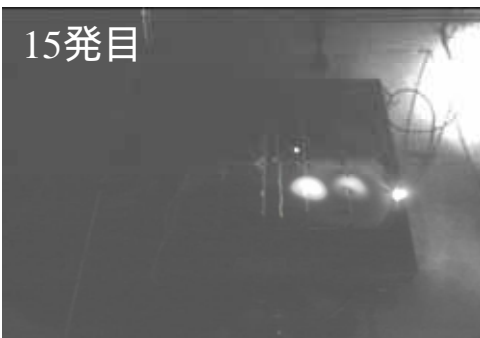
図 3.2-3 MD-1 放電劣化閾値測定試験 C_{ext}=96.5\text{nF} 時の放電
