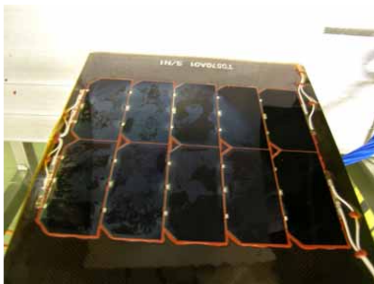
図 3.1-8 MD セル ESD 耐性比較試験後のクーポン外観
