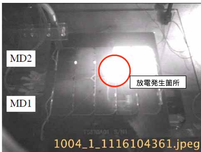
図 3.1-3 最初の試験回路での放電の状況
