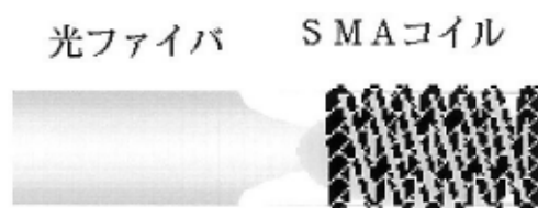
Fig.3.69 金属薄膜被覆法とテーパファイバの組合せ構造
