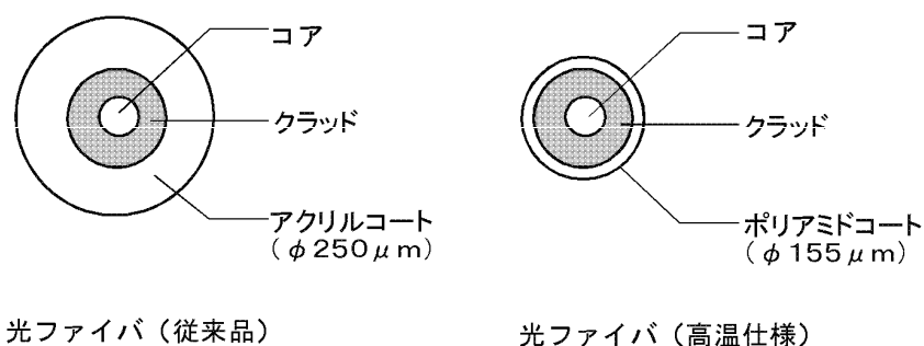
Fig.2.41 光ファイバの断面構造
