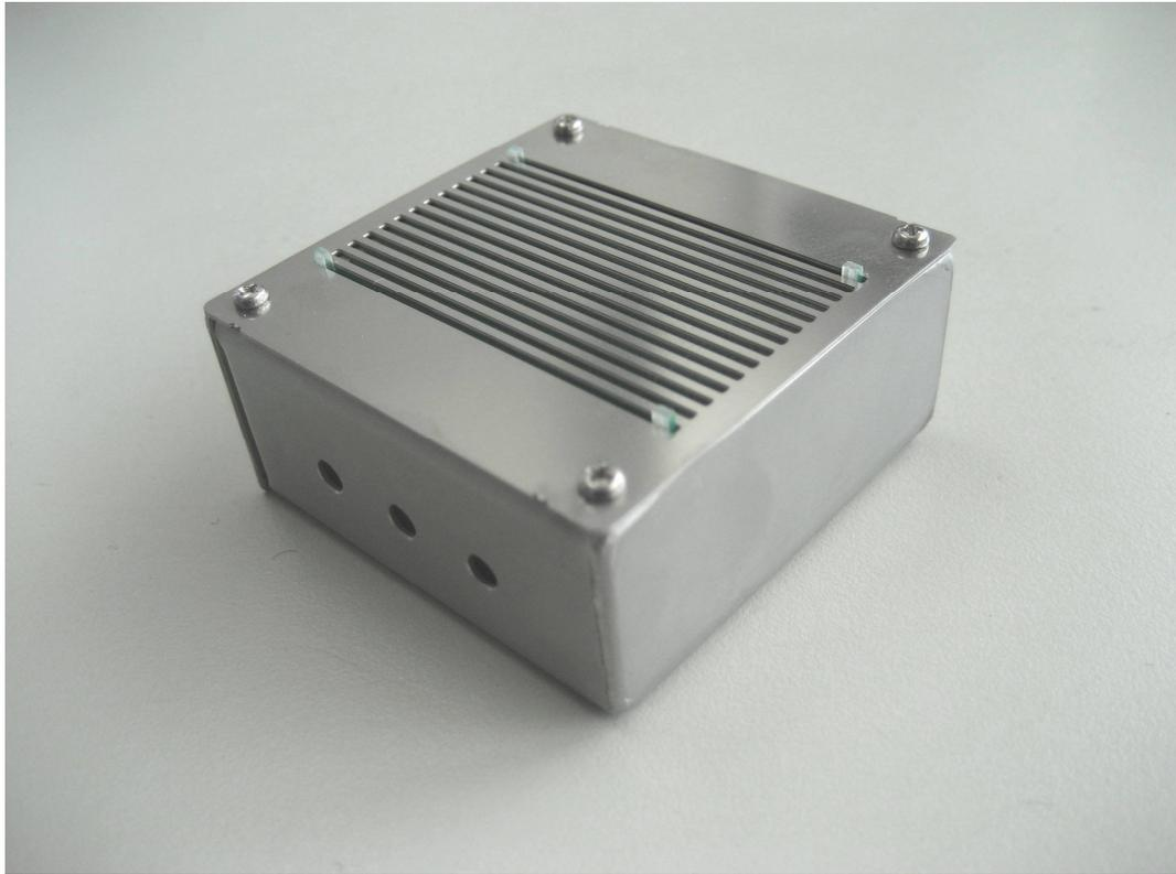
図 5-15 二段平行平板型静電分析器エンジニアリングモデルの試作機
