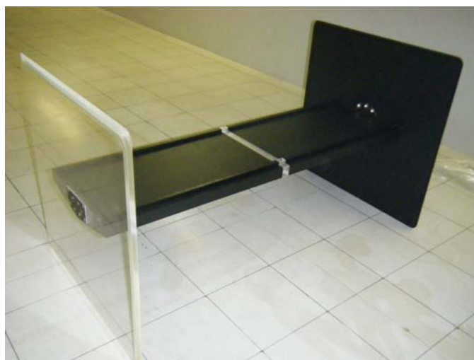
図 5-1-1 圧力測定実験および PIV 実験用模型
