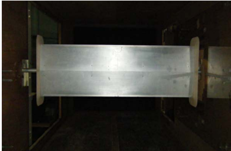
図 7-2-12 たわみ強制加振慣性力キャンセル時のひし形平板模型設置状況
