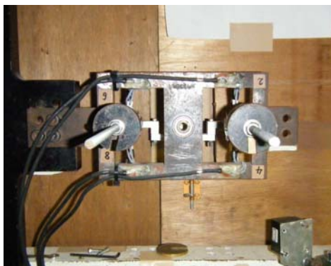
(a) たわみ加振時設置状況
