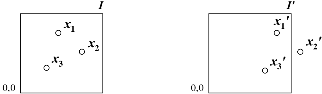
図 5-2-4 時刻 t で記録された輝度分布 I と \Delta t 後の t' で記録された輝度分布 I'
