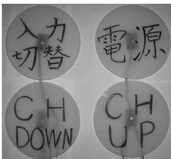
図5.34 : 簡単操作リモコンシステムの動作検証に用いた大面積光センサ
