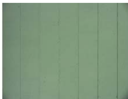
(b) ヘール工具による加工面
