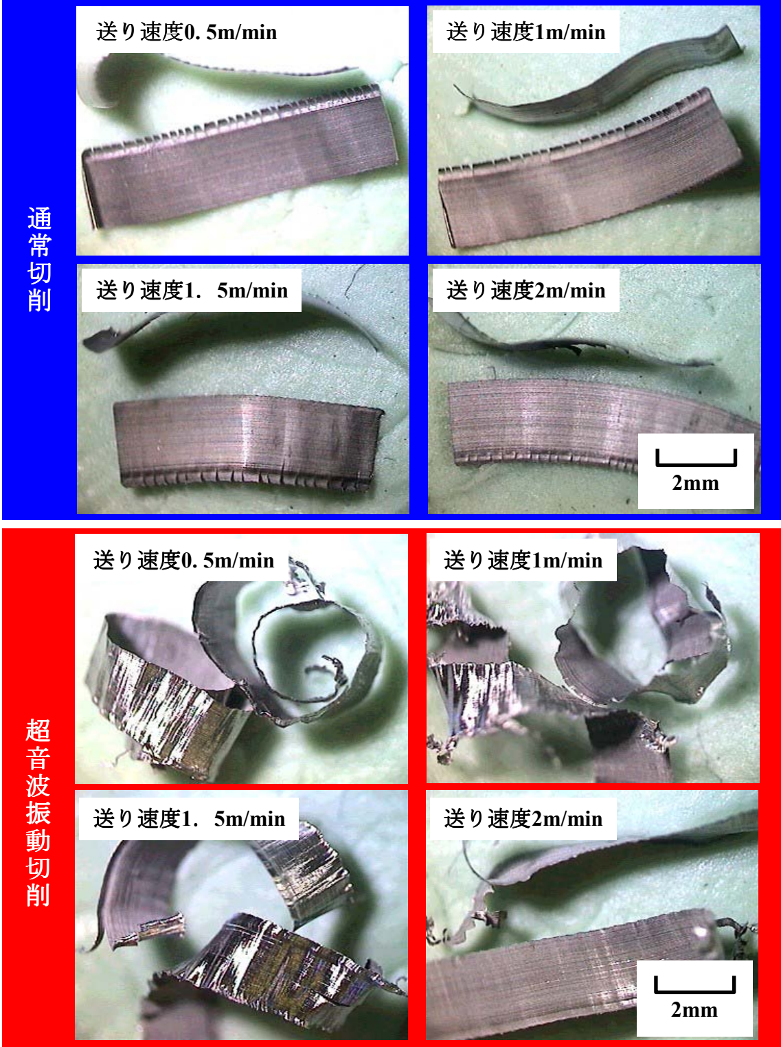
図 4-14 NAK80 の切り屑概観 (送り速度による影響)
