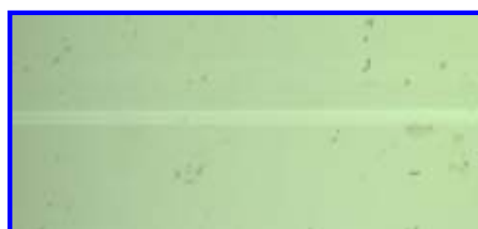
(a) 切り込み深さ 0.1\sim 0.16\mu\text{m}
