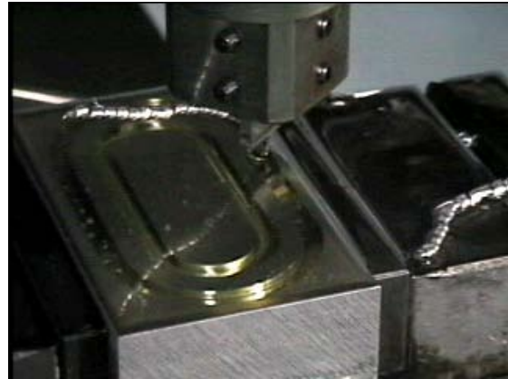
(b) ヘール工具による側面切削
