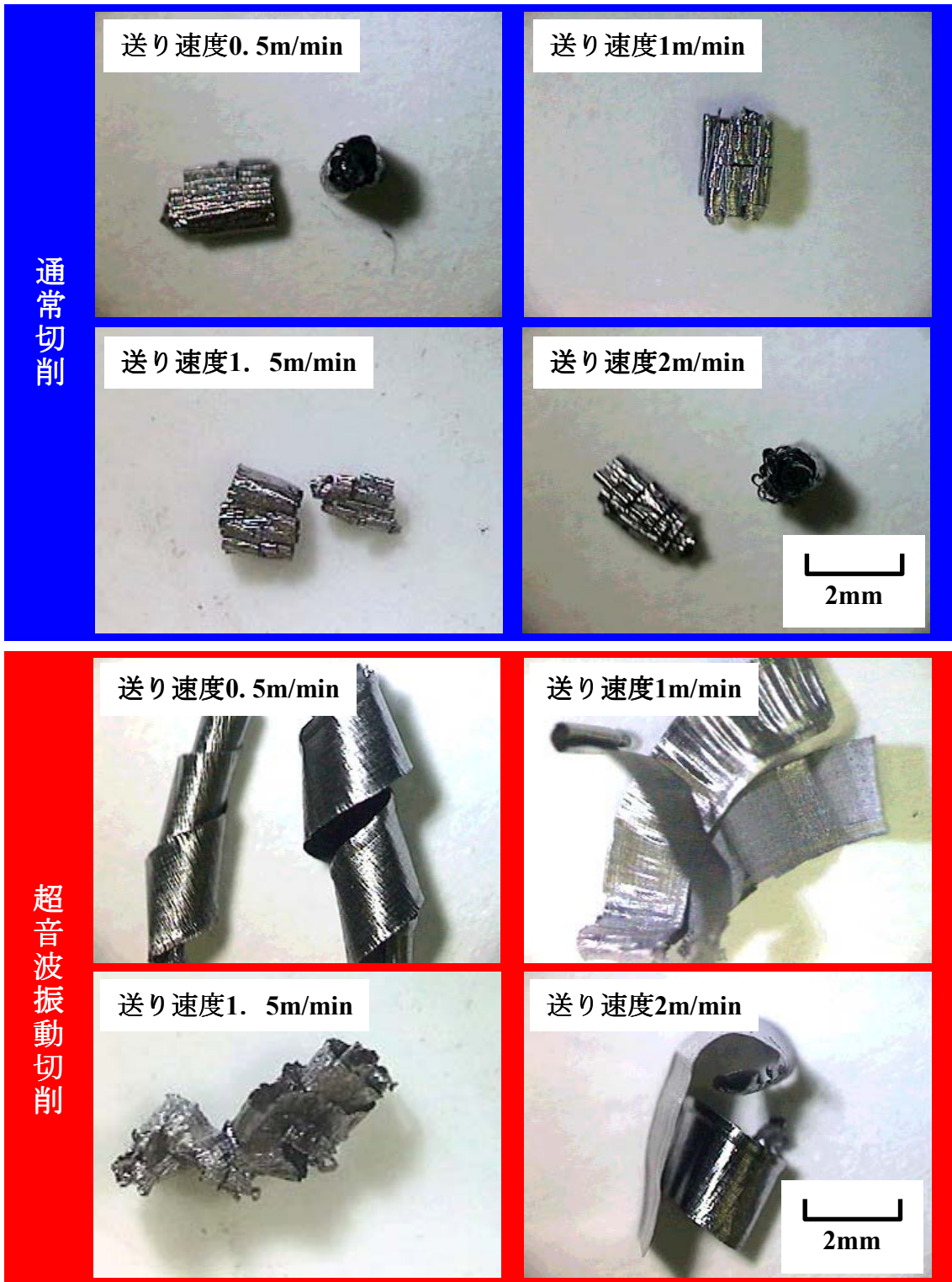
図 4-16 S55C の切り屑概観 (送り速度による影響)
