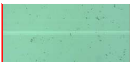
(a) 切り込み深さ 0.1\sim 0.16\mu\text{m}
