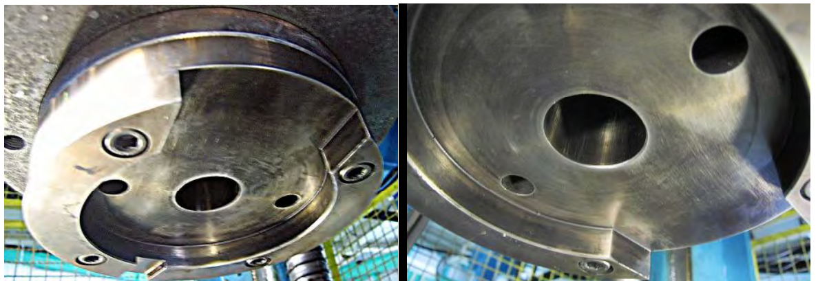
Fig.4.3.21 Outlook of upper extrusion die
