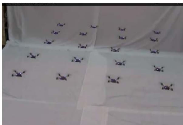
Fig. 1.1.1-2 Quad rotor MAV : Rotation wing
