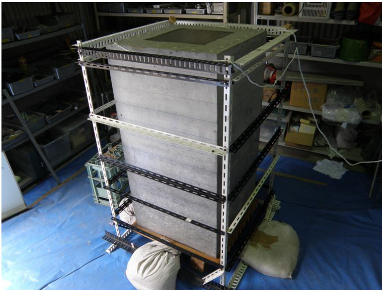
写真-3.10 アングル設置状況
