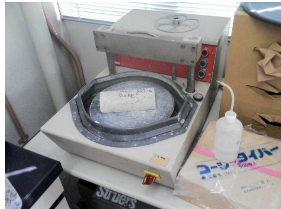
写真-5.6 切断面鏡面仕上げ
