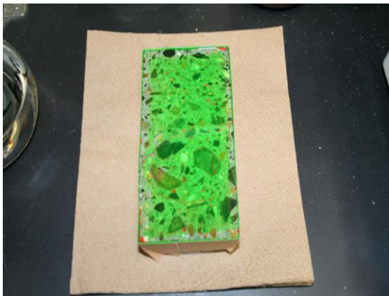
写真-5.7 蛍光樹脂塗布
