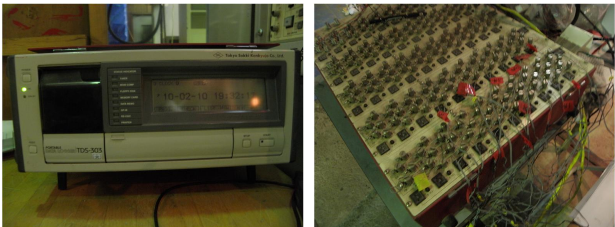
写真-3.12 鉄筋ひずみ測定機器（データロガー、スイッチボックス）
