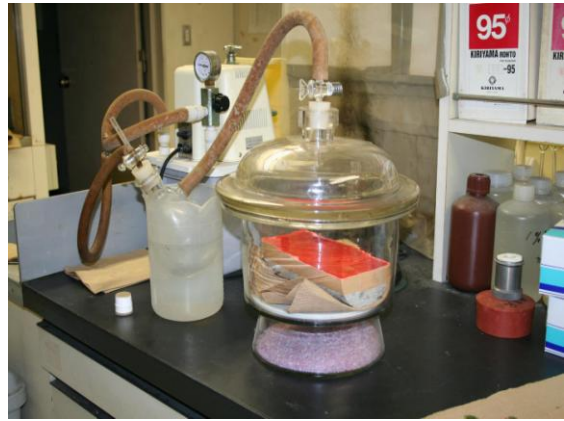
写真-5.8 乾燥による樹脂硬化
