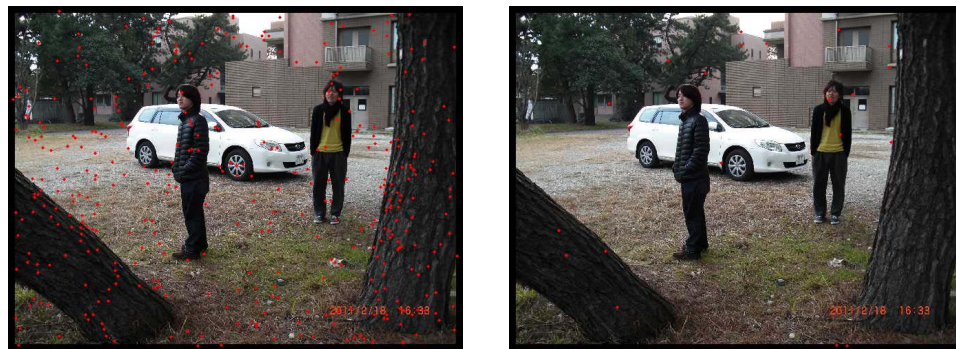
(a) SIFT によって抽出された全対応点 (b) GA によって選択された対応点
