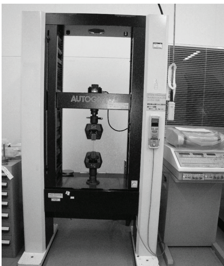
Fig. 2.2 万能試験機 (島津製作所: AG-5000E)
