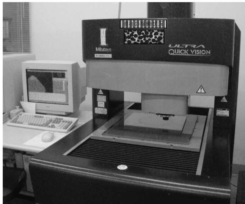
Fig. 2.8 非接触式三次元 CNC 画像測定機 (mitutoyo : ULTRA QV 350H)
