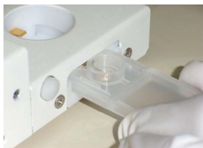
図 38. 電極モジュールのセット
