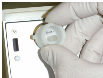
図 36. RC 電極ホルダーの取付
