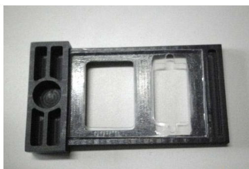
図 10. 電極ホルダーへのシリコンシートの装着
