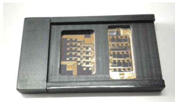
図 14. 25pin 電極モジュール完成品
