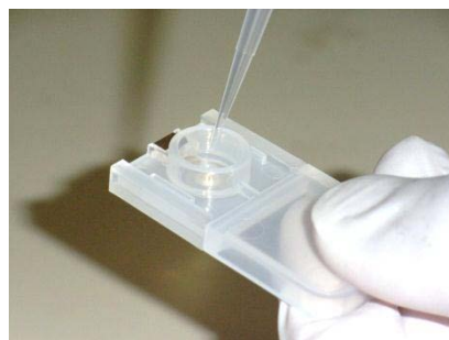
図 37. ウェル部への電解液注入
