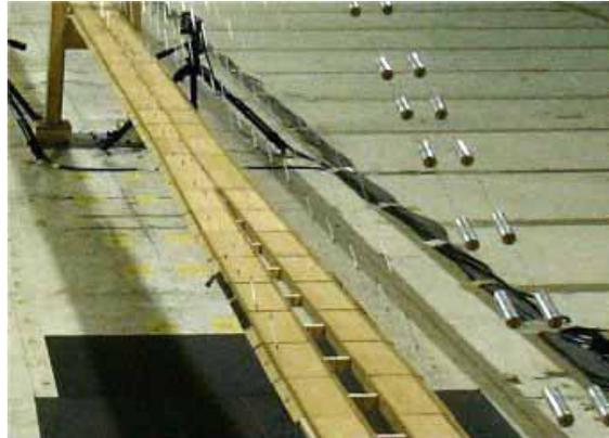
写真 3.2.1 一箱桁と二箱桁の遷移区間
