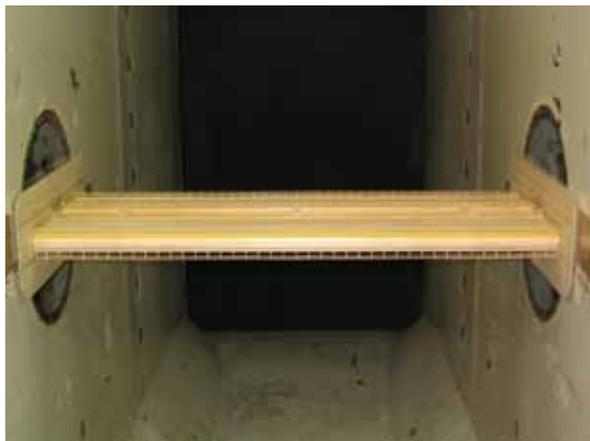
写真 4.2.2 風洞風路内に支持された試験模型
