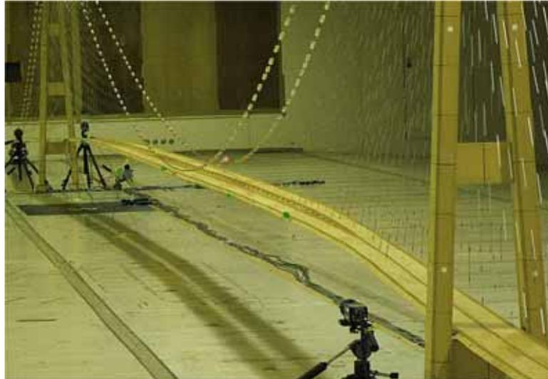
写真 6.5.1 高風速域の全橋模型の横たわみ変形状況
