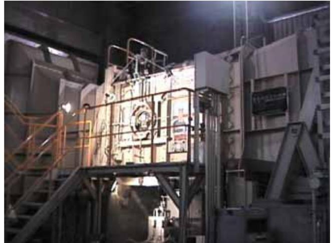
写真 4.2.1 非定常空気力風洞のバネ支持試験設備外観
