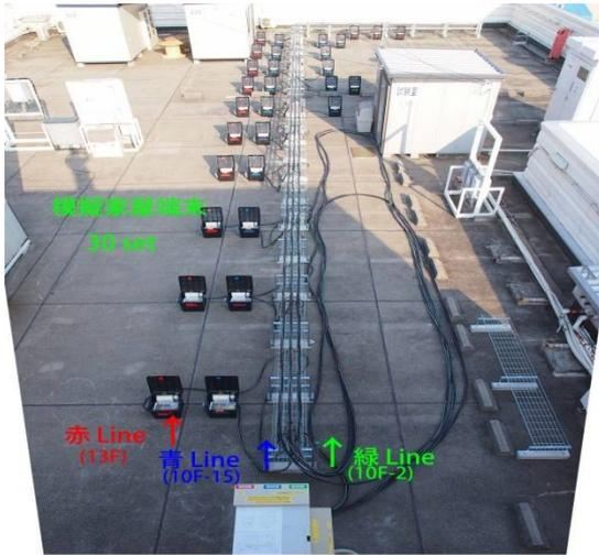
写真 3. 1 埼玉エンジニアリングの集合住宅疑似配線
