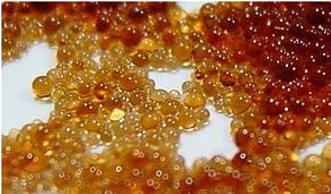
図 1 - 2 イオン交換樹脂の粒子構造
