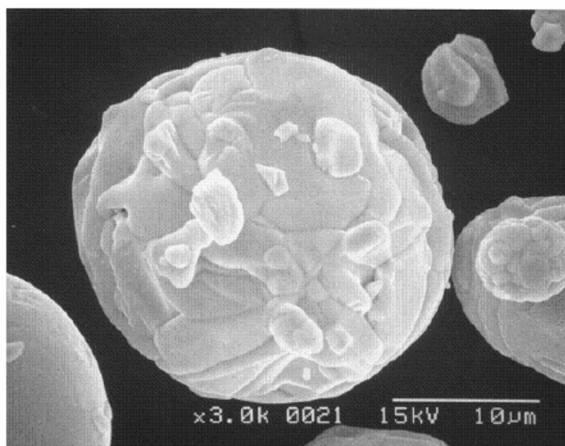
Fig. 3.4 SEM による原料粉体観察画像
