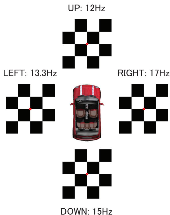
図 2.8: SSVEP-based BCI を用いた二次元平面上のレーシングカーを制御する方法の例
