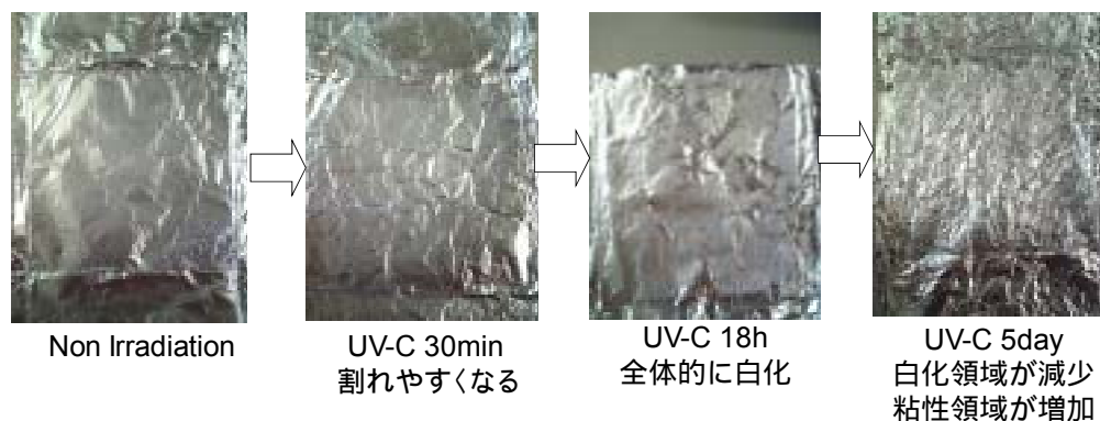
Fig. 8. UV-C 照射時間と外観の変化
