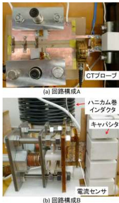
図 4 テストベッドの主な構成
