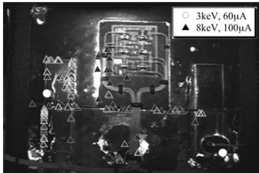
第 8 図 クーボン A の電子ビーム照射時における放電発生位置
