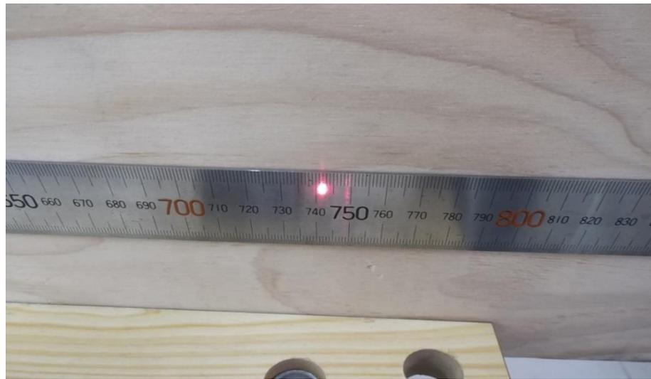
図 3-5 ターゲットボードのスケールに照射されたレーザ光
