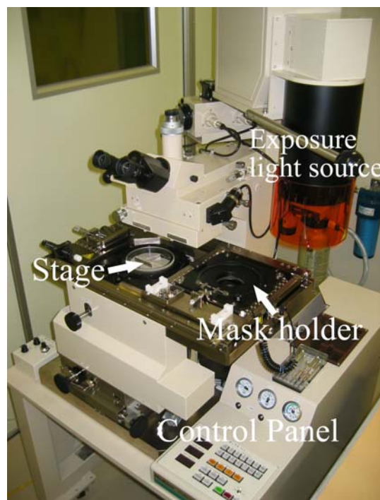
Fig.2.7 両面マスクアライナ装置（PEM-800, Union）
