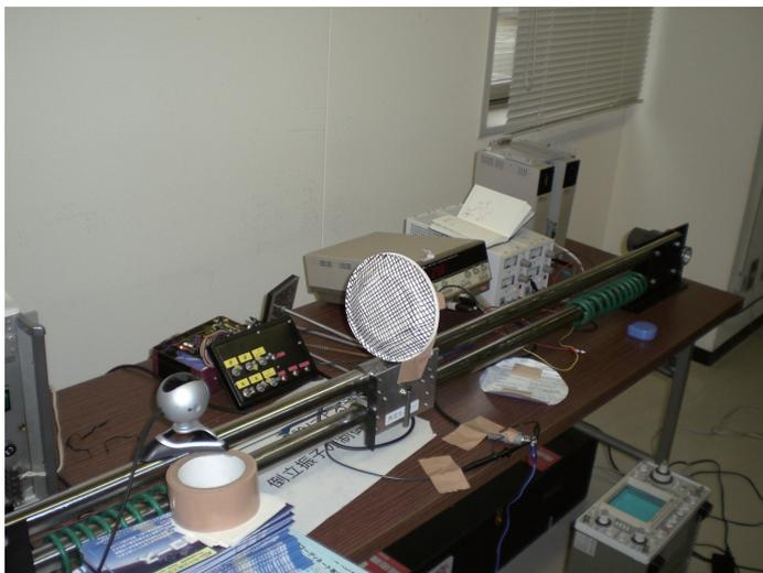
図 3.14: 倒立振り子デモ装置を使った衝突時間算出実験.
