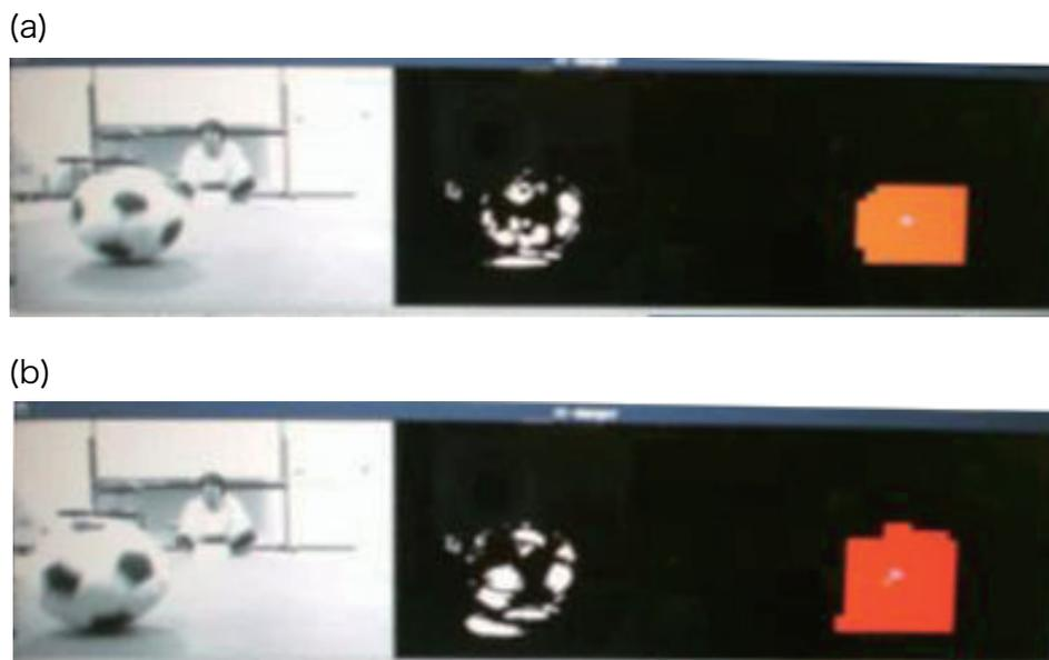
図 4.8: 実験 A における衝突回避時の反応状況. (a) 衝突時間回避閾値で回避した場合, (b) 危険度回避閾値で回避した場合
