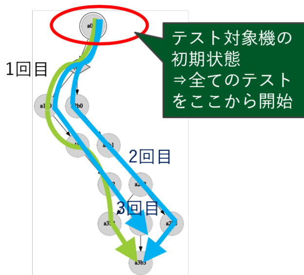
図 4.6 実行テストにおける非決定的振る舞いを網羅するテストの進め方
