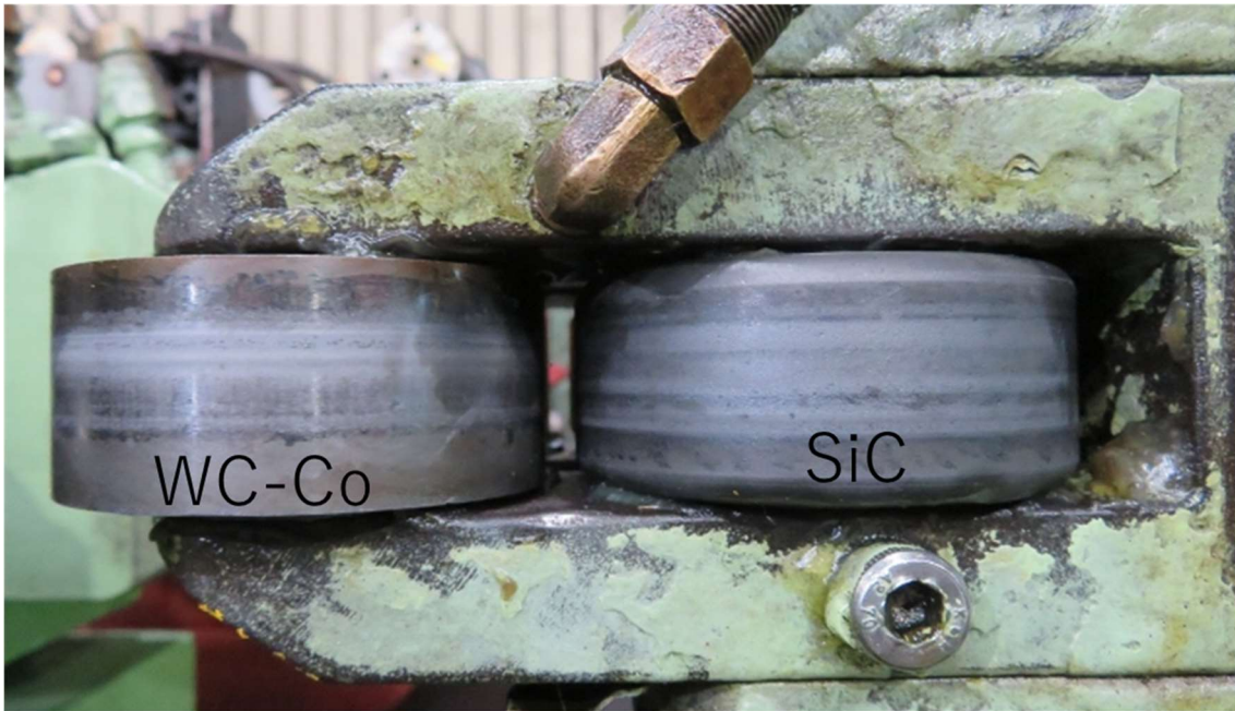
図 6.8 SiC ガイドローラー設置状況
