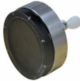
東京大学 生産技術研究所が開発した音響厚み 計測装置の200kHzパラメトリックプローブ
