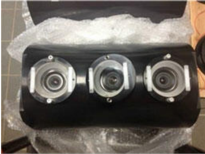
「AE2000f」に搭載された 3次元画像マッピング装置
